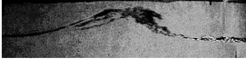
Рис. 4. Ветровой солитон в кольцевом канале. Видно частичное обрушение переднего фронта. Реальный размер поля течения составляет \sim 1 : 0.2 м.
