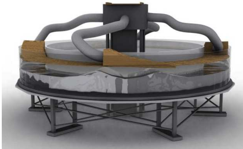
Рис. 1. Фотография экспериментальной установки. Кольцевой канал.
